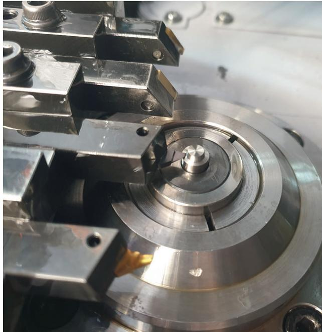
Die besondere Hartmetallsorte, die für Dieterle-Werkzeuge verwendet wird, hat laut Hersteller eine solche Beschaffenheit, dass beim Bearbeiten verschiedenster Werkstoffe maximale Standzeiten erreicht werden
